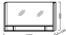
EB1183 Зеркало, 120 x 13 x 68,5 см, светодиодная подсветка справа и слева, полочка из цельного дерева
